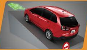
HSA陡坡起步輔助系統 上坡時放開煞車起步瞬間，車輛不後溜(2秒內)防止意外發生。
